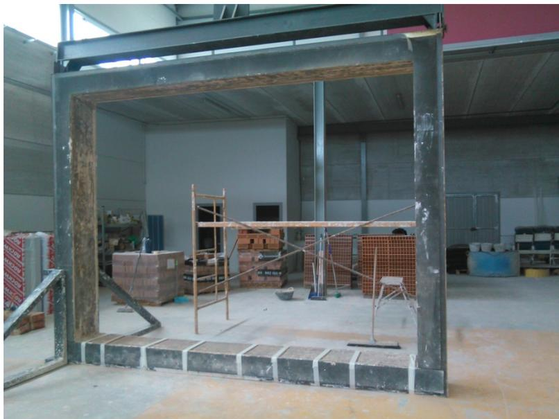
**Fotografía 04.** Premarco utilizado para la realización del montaje
